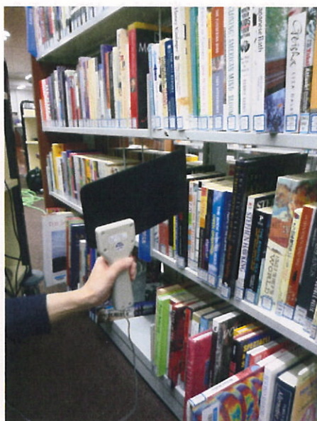
ハンディスキャナを使って I Cタグの情報を読み取る。
